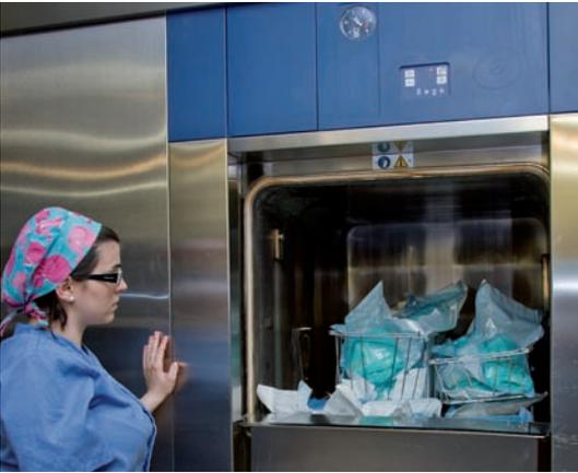
Fig. 31.4. Autoclave de vapor utilizado en una central de esterilización.
